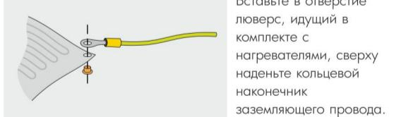
Вставьте в отверстие люверс, идущий в комплекте с нагревателями, сверху наденьте кольцевой наконечник заземляющего провода.
