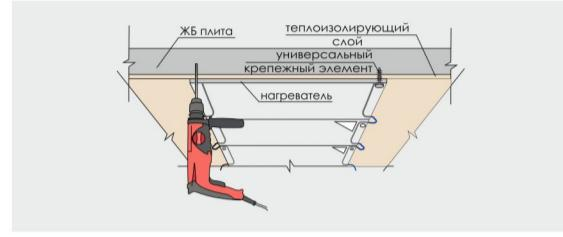
Монтаж лент нагревателей и теплоизоляции на перекрытия из дерева (фанеры) осуществляется аналогично способу крепления на деревянные рейки. Монтаж на ГКЛ, ГВЛ, ОСП, СМЛ, ДСП, ДВП, пластиковую вагонку, сэндвич панели выполняется только с помощью саморезов с пресс-щайбой.
