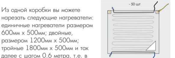
Из одной коробки вы можете нарезать следующие нагреватели: единичные нагреватели размером 600мм x 500мм; двойные, размером 1200мм x 500мм; тройные 1800мм x 500мм и так далее с шагом 0,6 метра, т.е. в один нагреватель. Пределная (максимальная) длина одной ленты составляет 6 метров или десять нагревателей. **ВАЖНО!** Изготавливать отрезки длиной, превышающей 10 нагревателей или 6 метров **НЕДОПУСТИМО**, т.к. магистральный провод, заполненный в нагреватель, не рассчитан на такую нагрузку.
