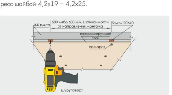
Следующим этапом монтируются ленты нагревателей при помощи шуруповерта, или мебельного степлера.
