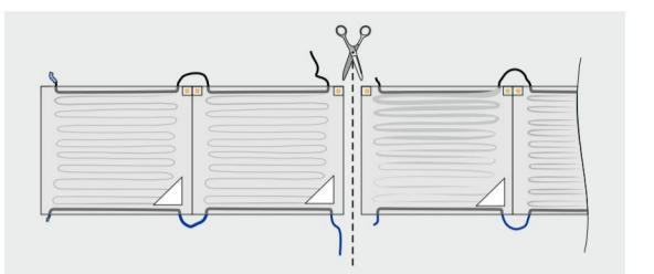
Изолирование туникового конца магистрального провода может производиться двумя способами – при помощи ТУТ или при помощи клеевого пистолета.
