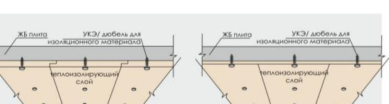
Крепление теплоизоляции можно осуществлять с помощью саморезов и шуруповерта, или при помощи скоб и мебельного степлера. Рекомендуем использовать саморезы с пресс-шайбой 4,2x19 – 4,2x25.
