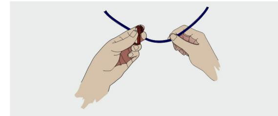
Для этого: большими пальцами рук надавливаем на торец ЗПО, а остальными натягиваем провод и надеваем ЗПО на магистральный провод.
