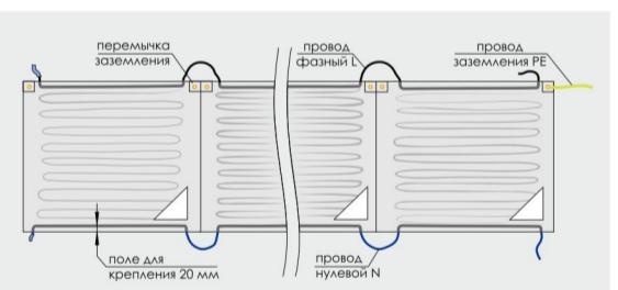
Поле ширины 20мм от бокового края нагревателя до фазного или нулевого провода предназначено для крепления нагревателя к потолочной поверхности.
