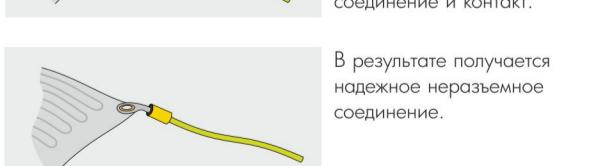
Обожмите эту конструкцию люверсовщиком со значительным усилием для того, чтобы обеспечить надежное соединение и контакт.
