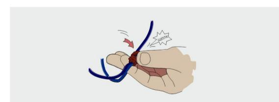
Коммутация этого соединения закончена. Аналогичную операцию нужно произвести с каждым проводом, соблюдая соответствие цветов проводников и выводов – все черные провода коммутируем с черной магистралью, синие с синей и желто-зеленые с желто-зеленой.
