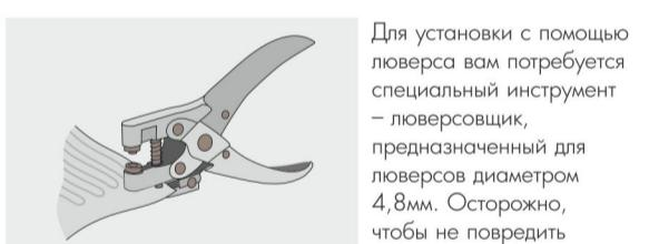
Для установки с помощью люверса вам потребуется специальный инструмент – люверсовщик, предназначенный для люверсов диаметром 4,8мм. Осторожно, чтобы не повредить
