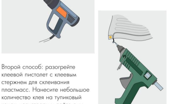
Второй способ: разогрейте клеевой пистолет с клеевым стержнем для склеивания пластмасс. Нанесите небольшое количество клея на туниковый конец магистрали и дайте ему затвердеть.
